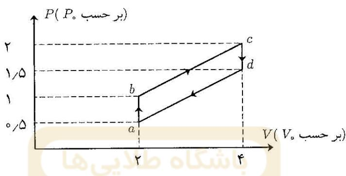
الف) برای هر یک از چهار بخش چرخه، مقدار کار انجام شده روی گاز،  $W$ ، و مقدار گرمای داده شده به گاز،  $Q$ ، را به دست آورید. تمام پاسخ‌ها بر حسب  $P_0$  و  $V_0$  باشد.
